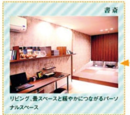
リビング・ダイニング 和室の間仕切り壁をなくし、床を高く、立ち上げ部分には間接照明を設けた。造作のリビングボードの向こうは書斎
